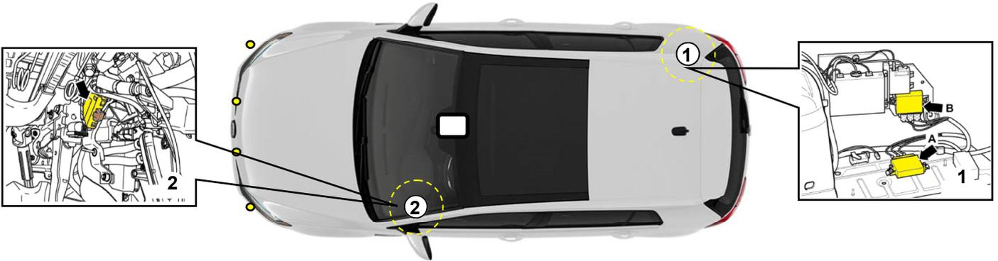
Una volta individuata la locazione della centralina sensori di parcheggio originale è necessario scollegare il connettore marrone A, quindi collegare il cablaggio del kit in serie tra il connettore OEM e la centralina originale dei sensori di parcheggio B.
