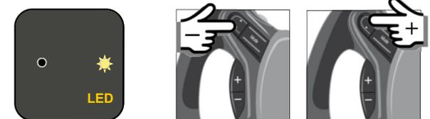
Una volta visualizzata l'opzione che ci interessa modificare, premendo VOLUME + sul volante incrementiamo il numero di lampeggi ROSSI del led variando conseguentemente lo stato dell'opzione.
