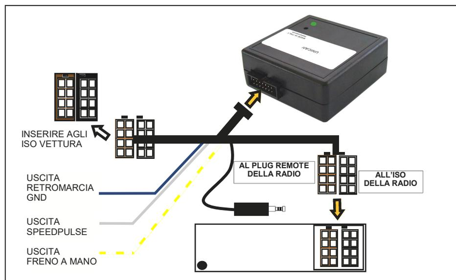
**Terminate le connessioni il LED del modulo si accenderà VERDE ad indicare il corretto funzionamento del sistema.**
