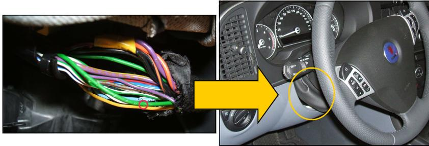
COLLEGARE IL CAVO **CAN H** DI MULTICAN AD UNO DEI DUE CAVI VERDI CHE SI TROVANO NEL FASCIO CAVI SOTTO LO STERZO.
