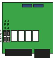
In caso la vettura sia provvista di amplificatore originale (booster) impostare i ponticelli JP3 e JP4 sul circuito come descritto in figura. Consigliamo comunque in presenza di booster di collegare uno speaker esterno seguendo sempre la configurazione descritta a fianco.
