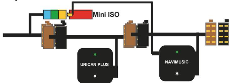
Collegare il connettore ISO del modulo Navimusic al connettore ISO della radio aftermarket. Collegare il plug adattatore di UNICAN PLUS per il controllo delle funzioni radio sul retro della radio aftermarket nell'apposito ingresso. Collegare il cavo GIALLO BIANCO di UNICAN PLUS al cavo GIALLO BIANCO del Navimusic quindi il cavo GIALLO BIANCO di Navimusic all'ingresso mute della radio.
