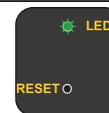
Il modulo di default presenta la prima radio selezionabile che è la CLARION, il LED VERDE esegue 1 LAMPEGGIO. La tabella in allegato indica la posizione delle radio. Per selezionare una radio differente premere VOLUME + per avanzare o VOLUME - per tornare indietro. Una volta scelta la radio confermare con SEEK +. Il LED VERDE diventerà fisso a conferma della selezione. Per le autoradio ALPINE, PIONEER e SONY è necessario anche posizionare il JUMPER JP1 correttamente (vedi tabella sotto).
