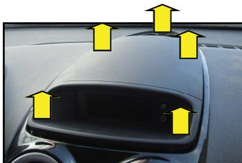
Una volta liberato dalla propria sede ruotare il display in modo da avere accesso al connettore Grigio. Rimuovere il connettore grigio sganciando la levetta di fermo.
