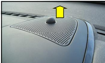
Una volta rimossa la griglia è necessario estrarre la vite torques che tiene assicurato il corpo in plastica del display
