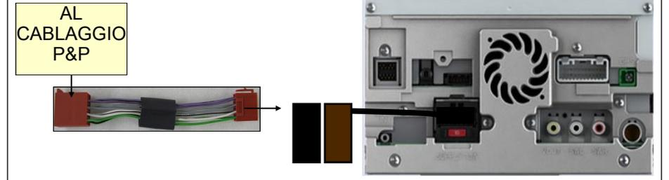
Per recuperare la presa USB OEM, usare il cablaggio mostrato sotto:
