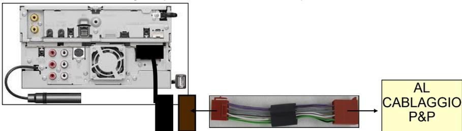
Per recuperare la presa USB OEM, usare il cablaggio mostrato sotto:
