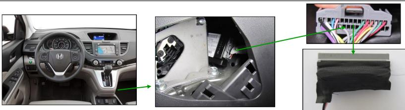
**ATTENZIONE! PER RECUPERARE I TASTI TELEFONO E' NECESSARIO COLLEGARE IL CONNETTORE DEL MODULO BLUETOOTH NEL TUNNEL CENTRALE DEL VEICOLO!**
