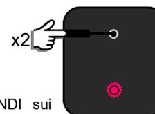
Premere velocemente RISPONDI sui comandi a volante, il LED di Unico lampeggerà una volta.
