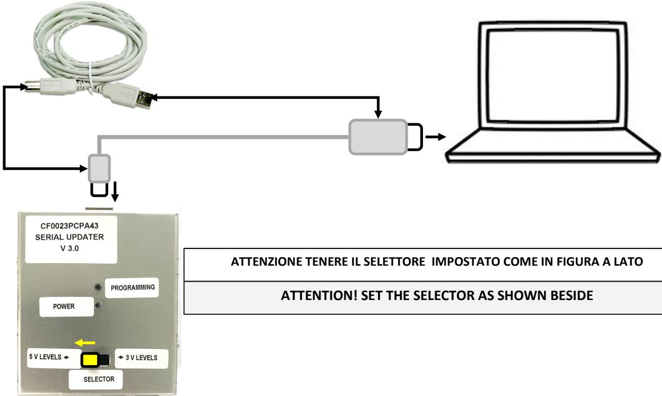
**ATTENZIONE TENERE IL SELETTORE IMPOSTATO COME IN FIGURA A LATO**
