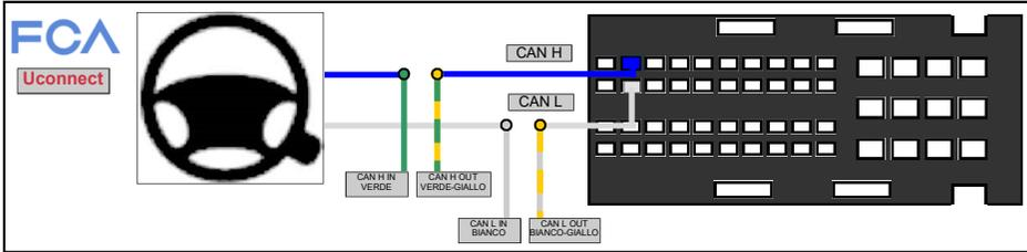
RADIO CONNECTORS ARE SEEN FROM THE WIRES BACK VIEW.
