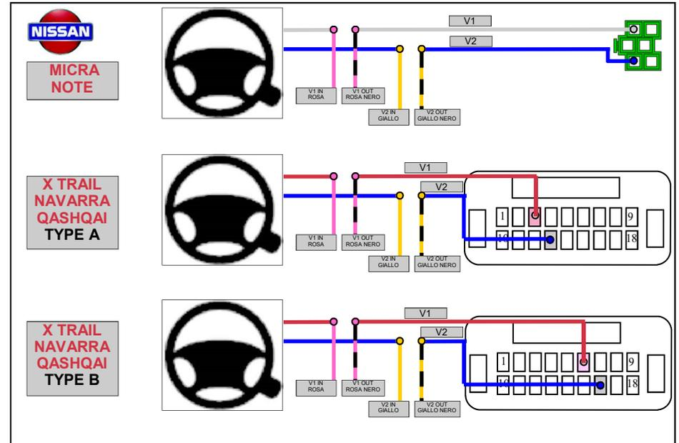
**RADIO CONNECTORS ARE SEEN FROM THE WIRES BACK VIEW.
