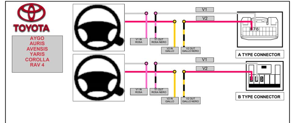
**RADIO CONNECTORS ARE SEEN FROM THE WIRES BACK VIEW.
