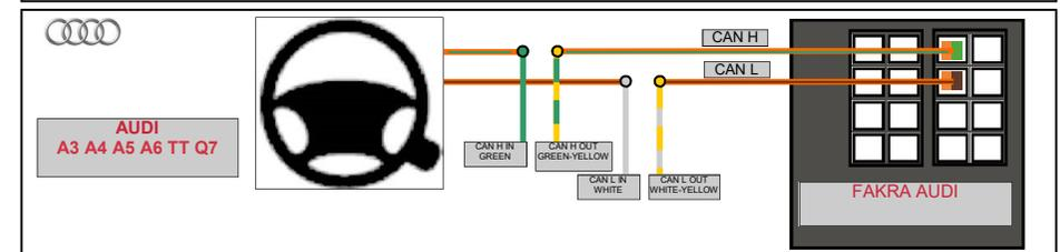
**RADIO CONNECTORS ARE SEEN FROM THE WIRES BACK VIEW.
