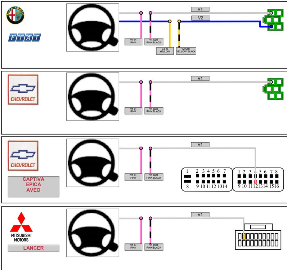
**RADIO CONNECTORS ARE SEEN FROM THE WIRES BACK VIEW.
