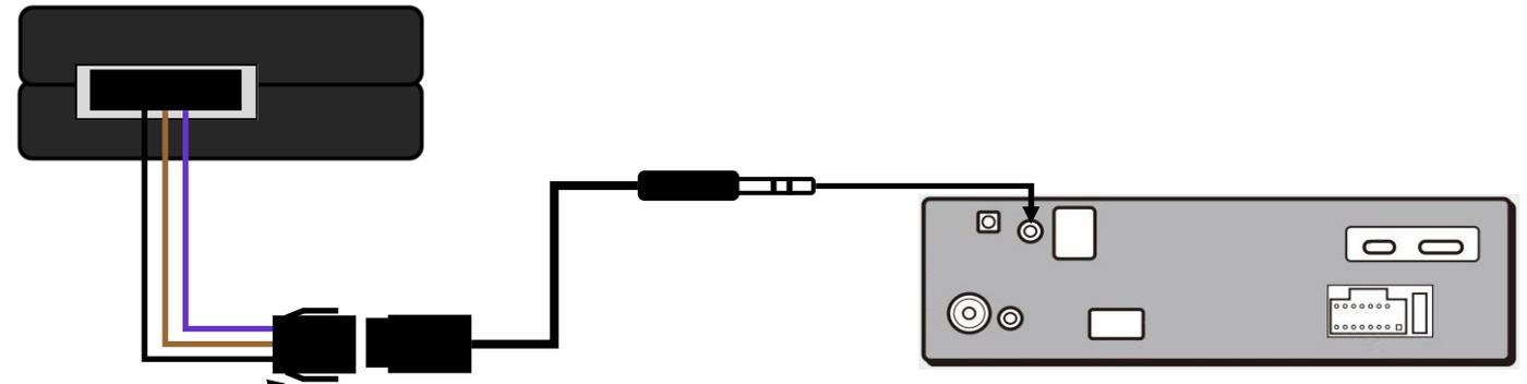
INSERT THE CBL007UNP12 RADIO ADAPTER INTO THE BLACK 4-WAY CONNECTOR OF THE HARNESS.
