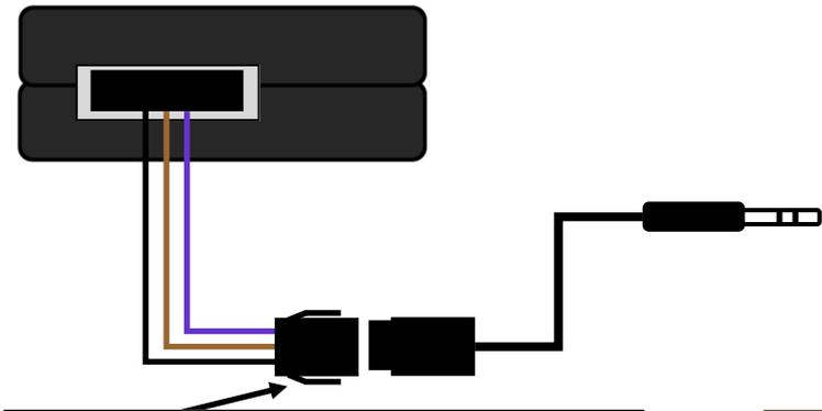
INSERT THE CBL007UNAL22 RADIO ADAPTER INTO THE BLACK 4-WAY CONNECTOR OF THE HARNESS.
