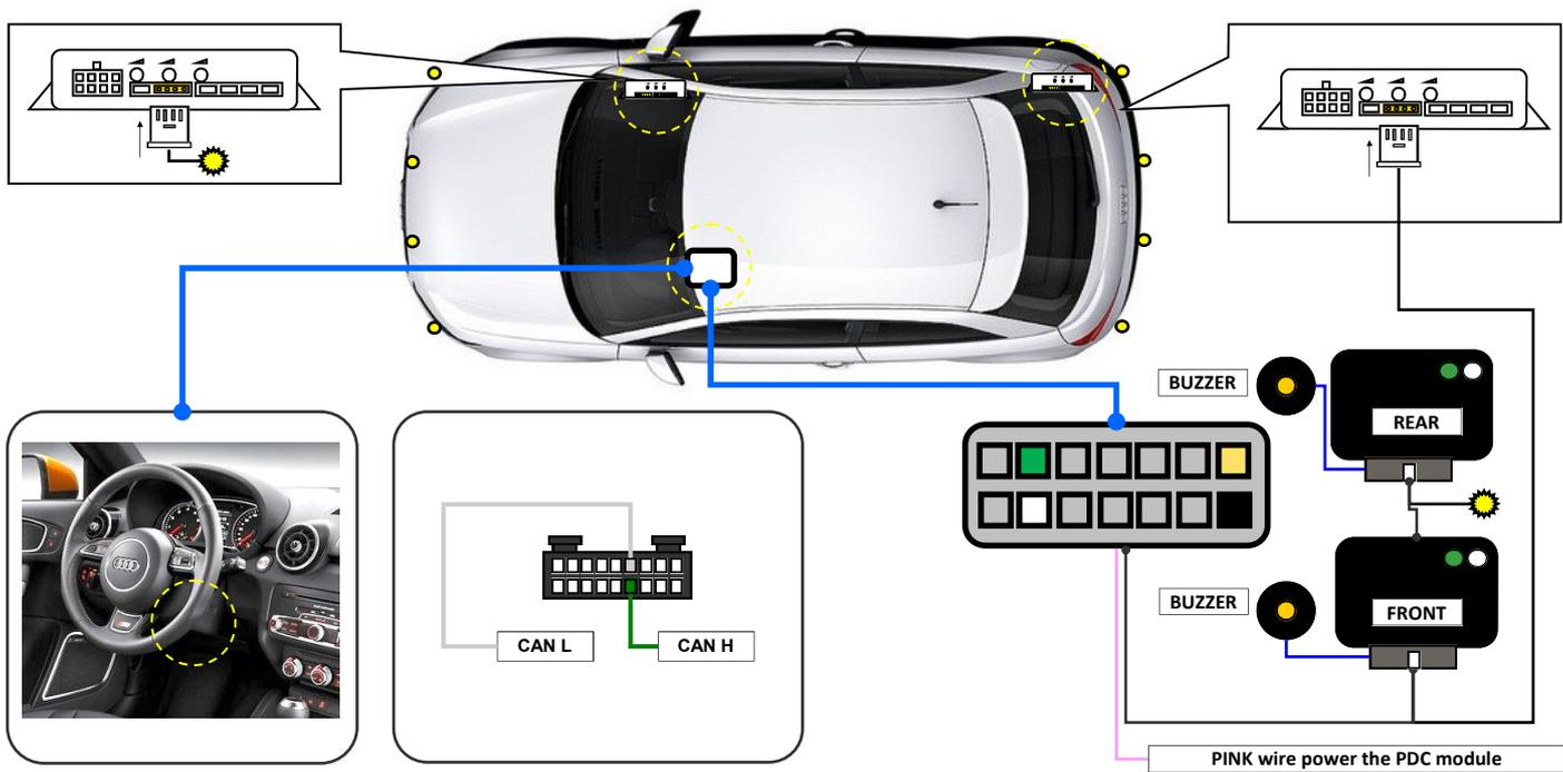
**THE SYSTEM STARTS TO WORK BY INSERTING THE BACK GEAR.
