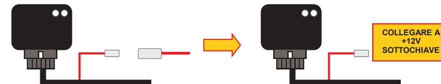
Interrompere la connessione del filo rosso tra l'interfaccia e il connettore OBD.
